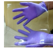
चित्र -4: वांछित आकार के माइक्रोवेव अवशोषक के निर्माण हेतु दृष्टिगत रूप से पारदर्शी (Optically transparent) परावैद्युत अंतरक (Dielectric spacer)
